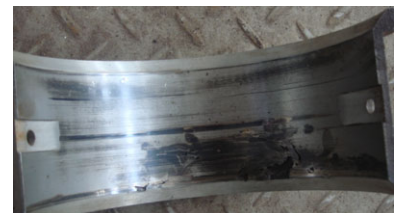
图六：连杆瓦因供油不足烧损
